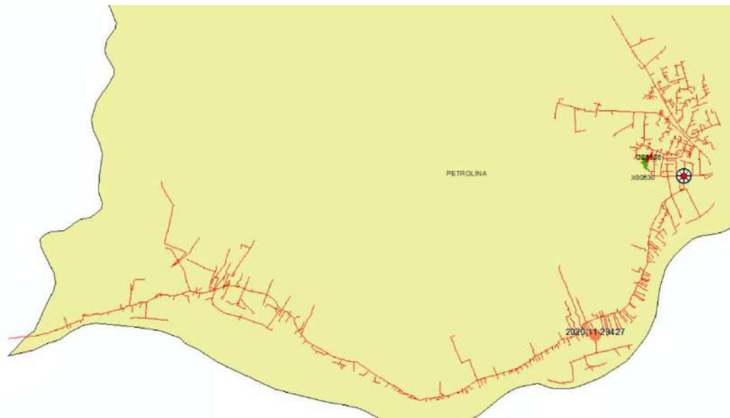
Figura 31 – Todos alimentadores do conjunto Petrolina II que sofreram interrupções parciais.
